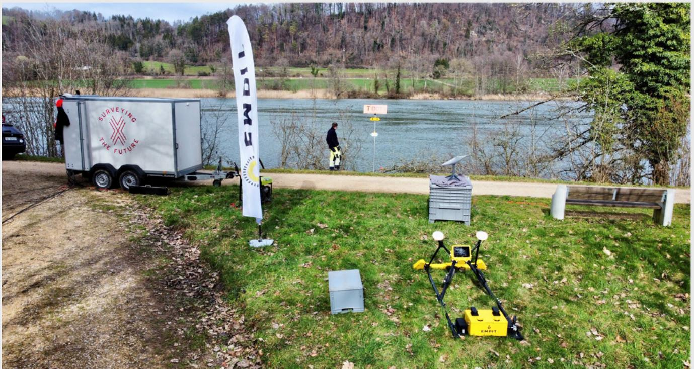
**Bild 4:** Messaufbau für das CMI. Im Anhänger links ist der Signalgenerator enthalten. Die Sensorarrays sind im tragbaren Detektor (gelb) verbaut und oberhalb des Detektors ist die Starlink-Antenne zu erkennen, die die hohen Datenmengen direkt in die Cloud für die sofortige Verarbeitung sendet
