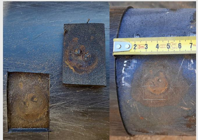
**Bild 6:** Mit CMI identifizierte Fehlstellen. Links: Herausgetrennte 3LPE-Umhüllung. Rechts: Nahbereich der Fehlstelle mit enthaftelem Bereich
