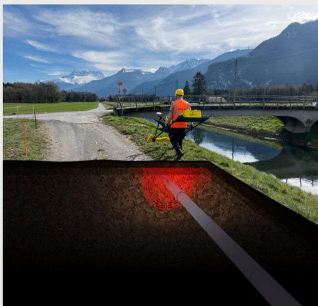
**Bild 8:** Handgeführter CMI-Detektor im Einsatz. Die roten kreisrunden Linien um die Rohrleitung illustrieren das durch den Signalgenerator erzeugte Magnetfeld
