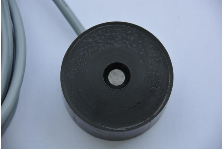
Bild 4: Angriffstiefen-Probeblech zur Erfassung der Korrosionsangriffs über die Zeit.
