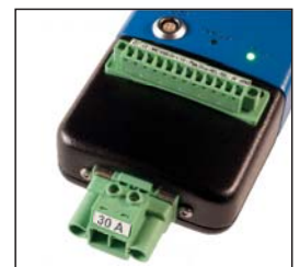
Elektronisches Relais 30 A zum Takten und für die Schutzanlagensteuerung
